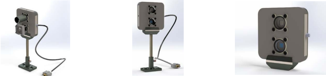
Şekil 1. Prototipleme tamamlanan çift açıklı optik güç ölçer
